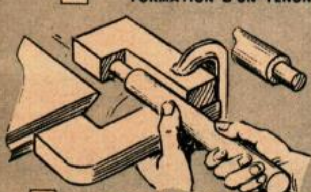
14 COUPE ÉPAULÉE POUR LA FORMATION D'UN TENON ROND SUR UNE BARRE RONDE
