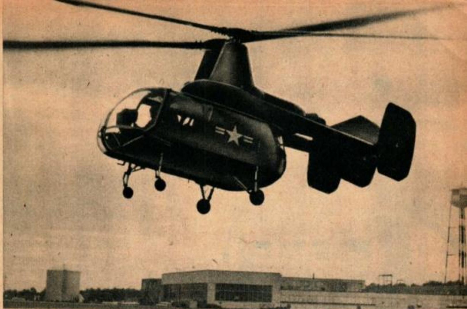
L'hélicoptère Kaman est équipé d'un moteur à turbine à gaz de 825 HP. Une version à turbo-propulseur du même moteur développe 960 HP.
