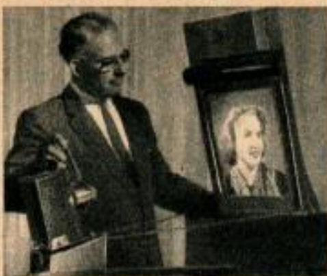
L'impression, la gravure ou la reproduction d'un matériau se fait à l'aide d'un procédé électronique simple et bon marché. Un système de charge (à gauche) dépose une couche d'électrons sur une surface
