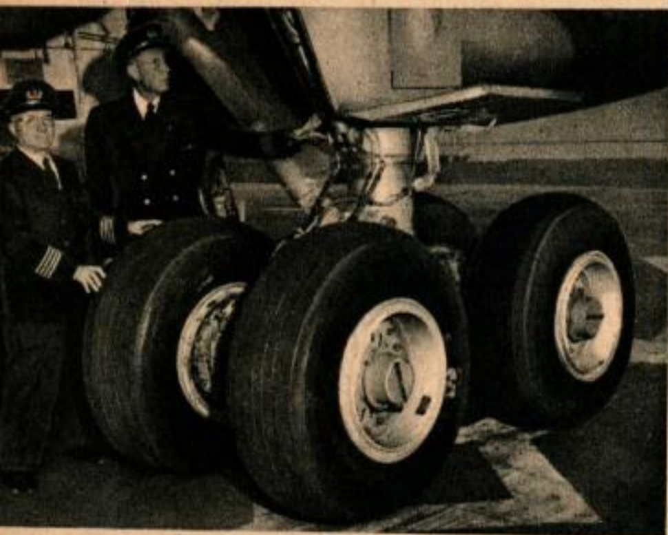
L'auteur (à droite) et le capitaine Bittner, l'un des premiers pilotes civils qui se soient entraînés pour le vol à réaction, étudient les quatre roues de l'un des éléments du train d'atterrissage.
