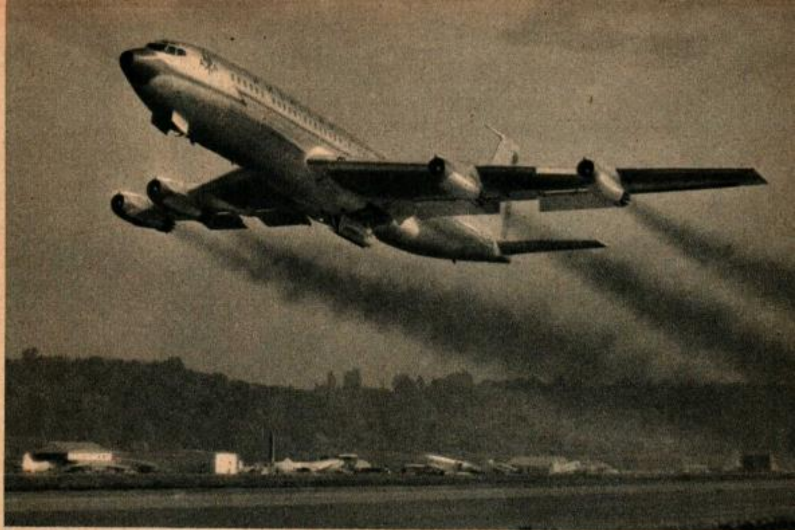
La fumée noire est produite par l'eau qui est pompée dans les quatre réacteurs au cours d'un décollage humide » effectué par une journée chaude.
