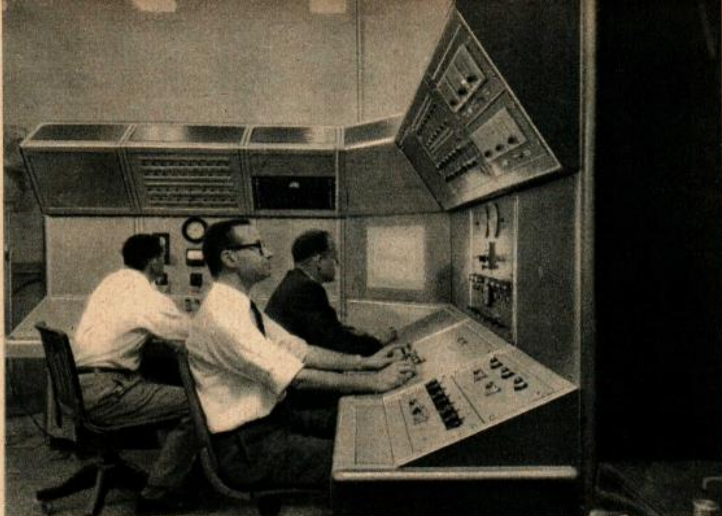
Voici le poste de contrôle lors d'un essai en soufflerie. Le modèle d'avion est visible sur l'écran central.
