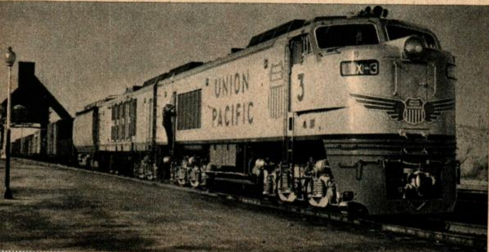
La première locomotive à turbine à gaz utilisée régulièrement sur les lignes de l'Union Pacific (ci-dessus) est déjà en service depuis plusieurs années ; sa puissance est de 4 500 ch. Ci-dessous : la nouvelle machine à turbine de 8 500 ch s'arrête à Evanston pour changer d'équipe de conduite.
