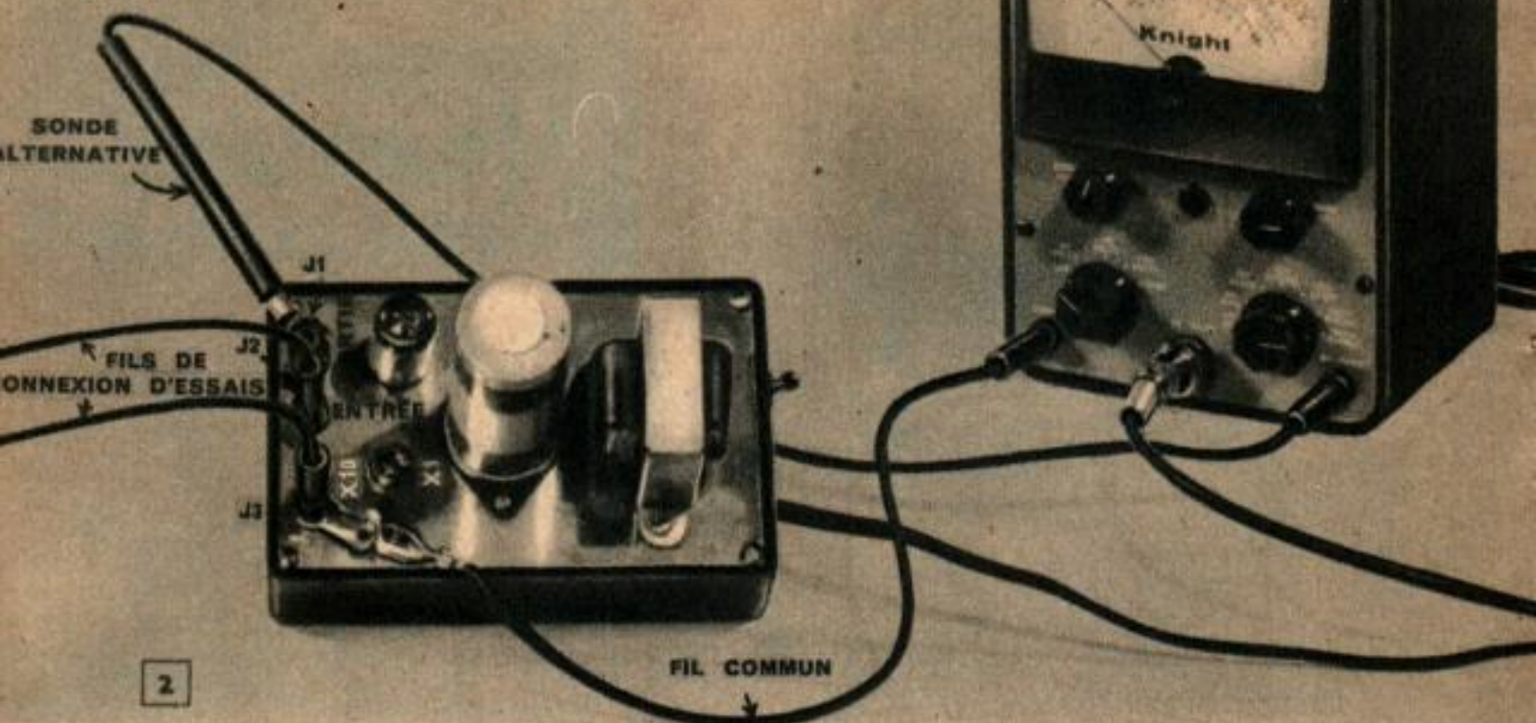
Le préamplificateur est connecté entre la source du signal et le V.O.L. Le signal est mesuré avec des fils de connexion d'essais séparés.
