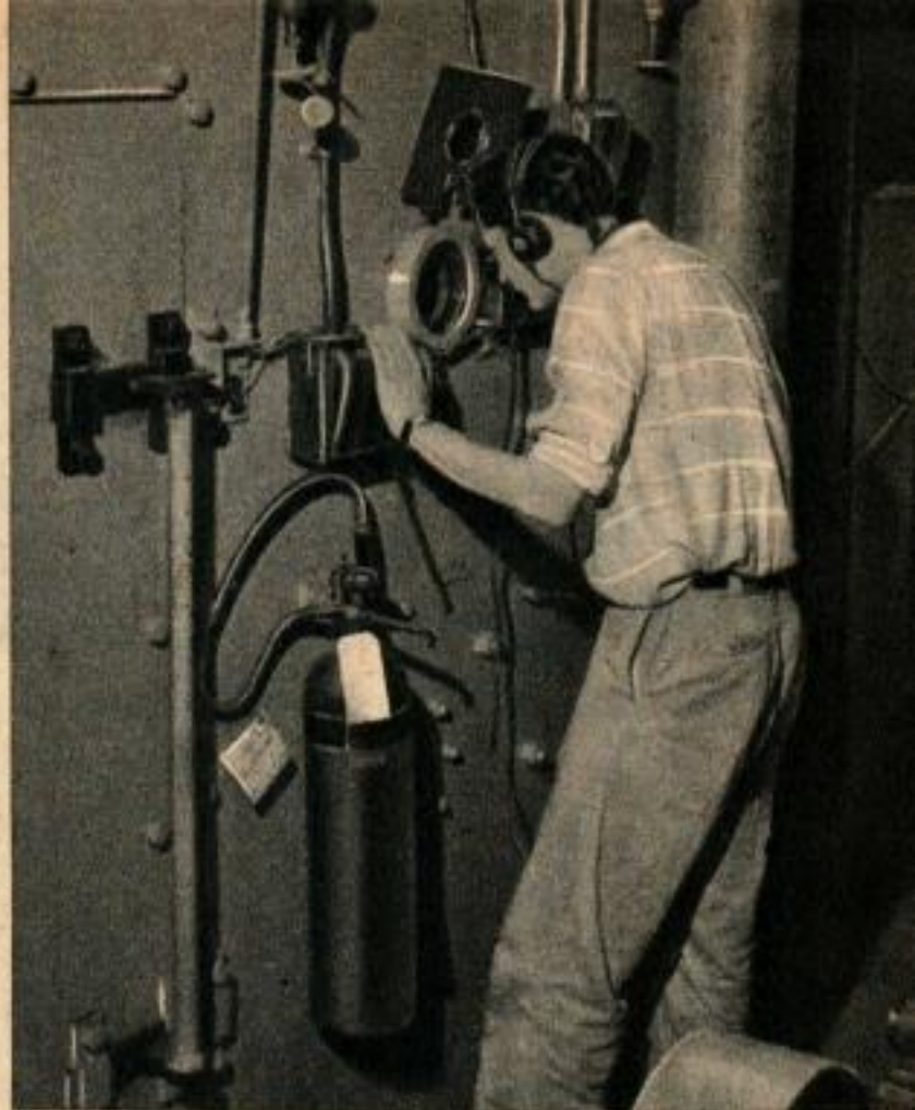
Un observateur surveille l'essai du moteur-fusée à travers le verre de sécurité du hublot. Les cloisons de la cabine aux essais sont des plaques de blindage en acier de 25 mm d'épaisseur.
