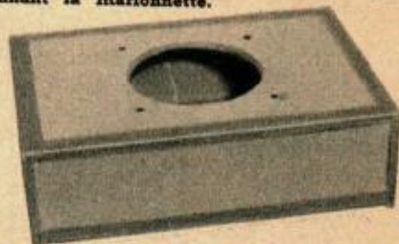
La base du théâtre est une boîte à cigares. Le haut-parleur préparé comme précédemment indiqué est monté par le dessous avec des vis et écrous.
