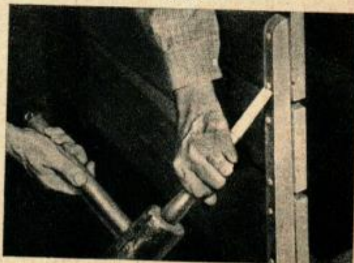
Ci-dessus : des vis enfoncées à travers les tasseaux de dessous servent à assembler les éléments avant et arrière. Ci-dessous : les vis fixant les planches du dossier sur les montants sont chambrées, leur tête est chevillée et les chevilles sont poncées à fleur du bois.
