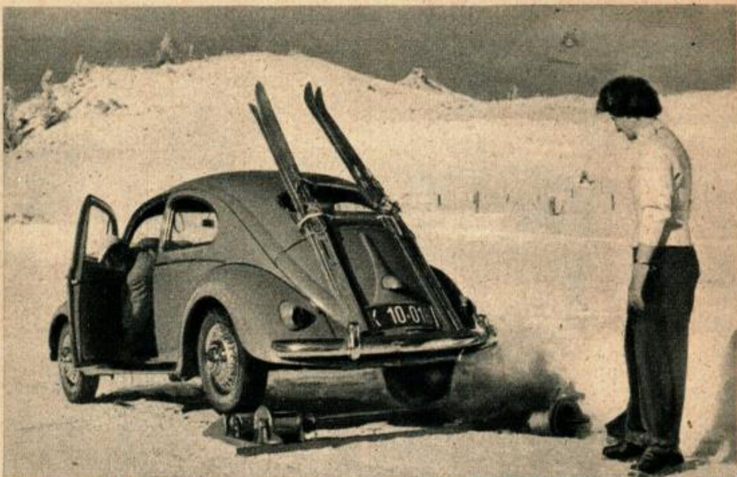
Les roues arrières de l'automobile employées pour actionner le ski-lift reposent sur des cylindres montés à chaque extrémité de l'axe de rotation.
