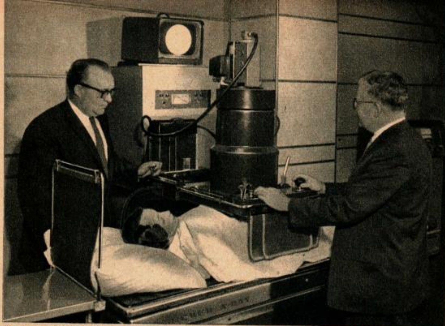
Cet amplificateur de projection radioscopique mis au point par la « Rauland Corporation » permet aux médecins d'observer le cœur d'un malade sur un écran de télévision.
