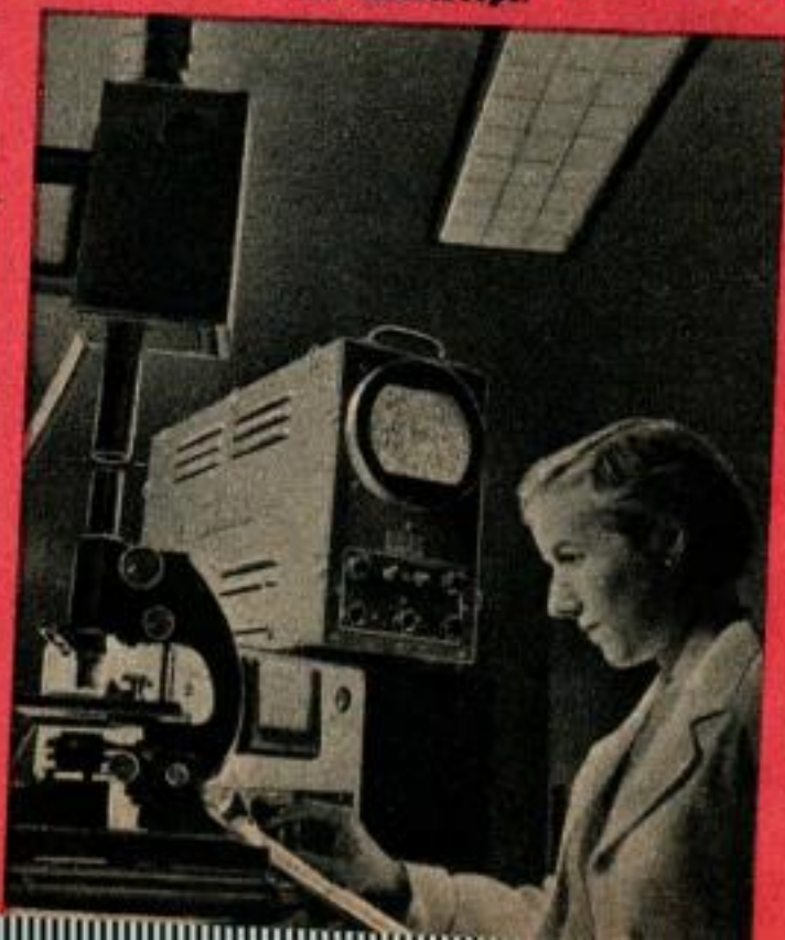
Cette technicienne de laboratoire obtient un rapide compte électronique des cellules du sang. Un appareil de surveillance électronique contrôle la mise au point du microscope.
