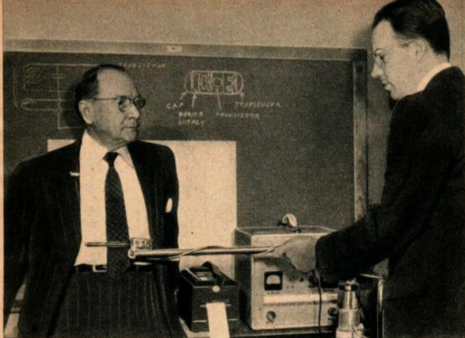
Un savant démontre comment les informations médicales émises par la « pilule radiophonique » se trouvant à l'intérieur du malade sont captées avec une antenne spéciale.
