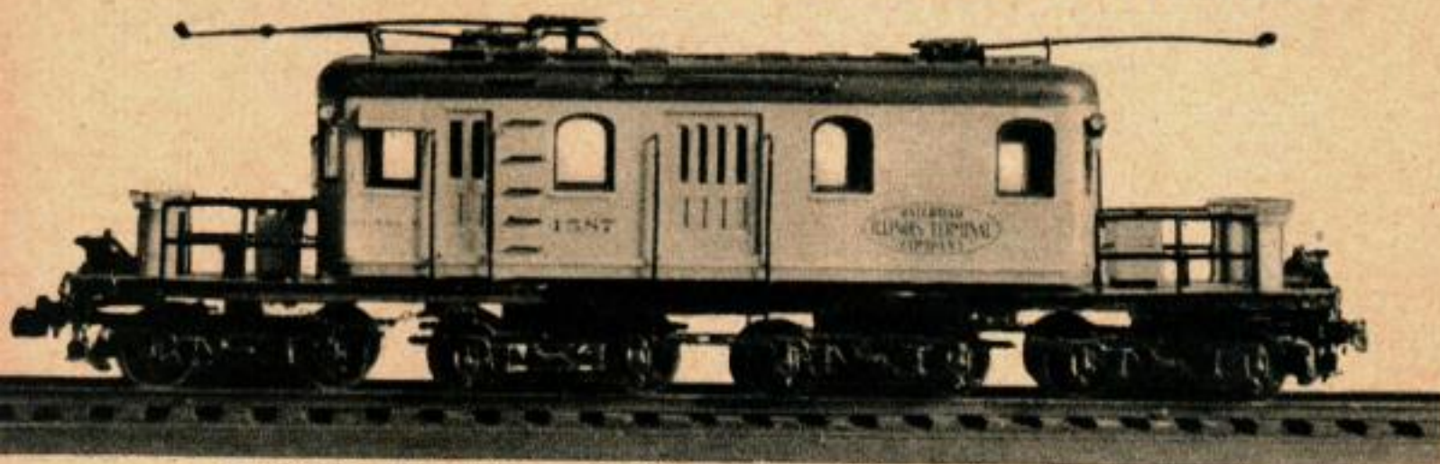
Ce modèle, qui n'est long que de 19 cm, est construit en feuilles « Strathmore », avec des boggies et des perches métalliques.
