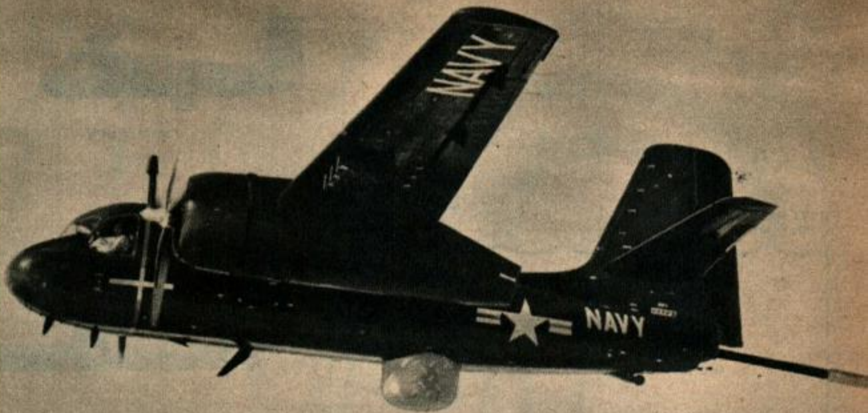
Les tout derniers perfectionnements de la chasse sous-marine comprennent le dôme radar que l'on voit sous le nez et le détecteur magnétique que l'on voit déployé à l'arrière.
