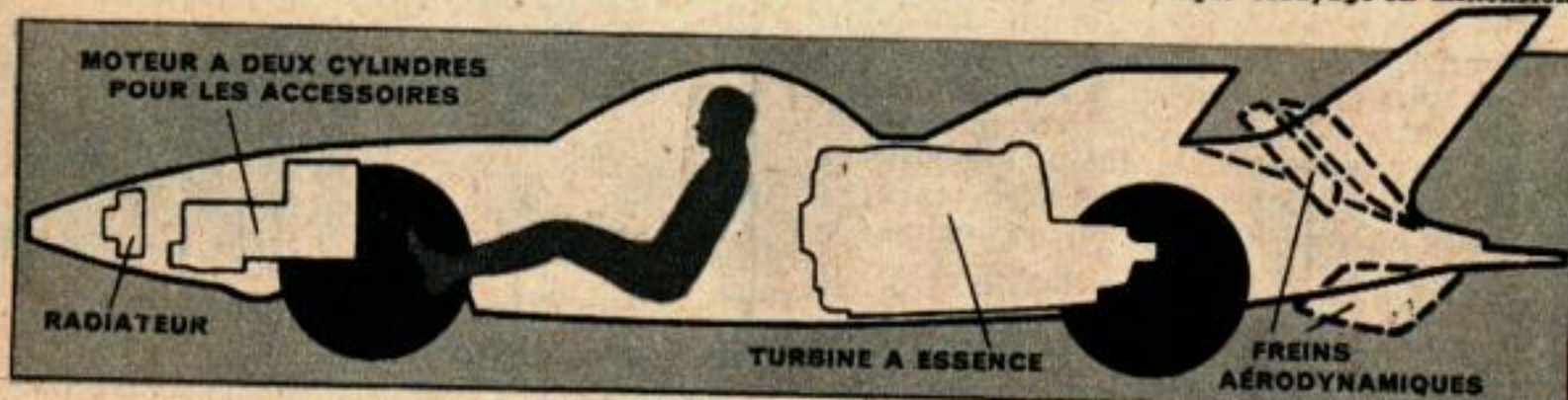
Le moteur auxiliaire est logé dans le cône de pointe. Les freins aérodynamiques s'ouvrent comme des coquillages pour ralentir la voiture lancée à haute vitesse.
