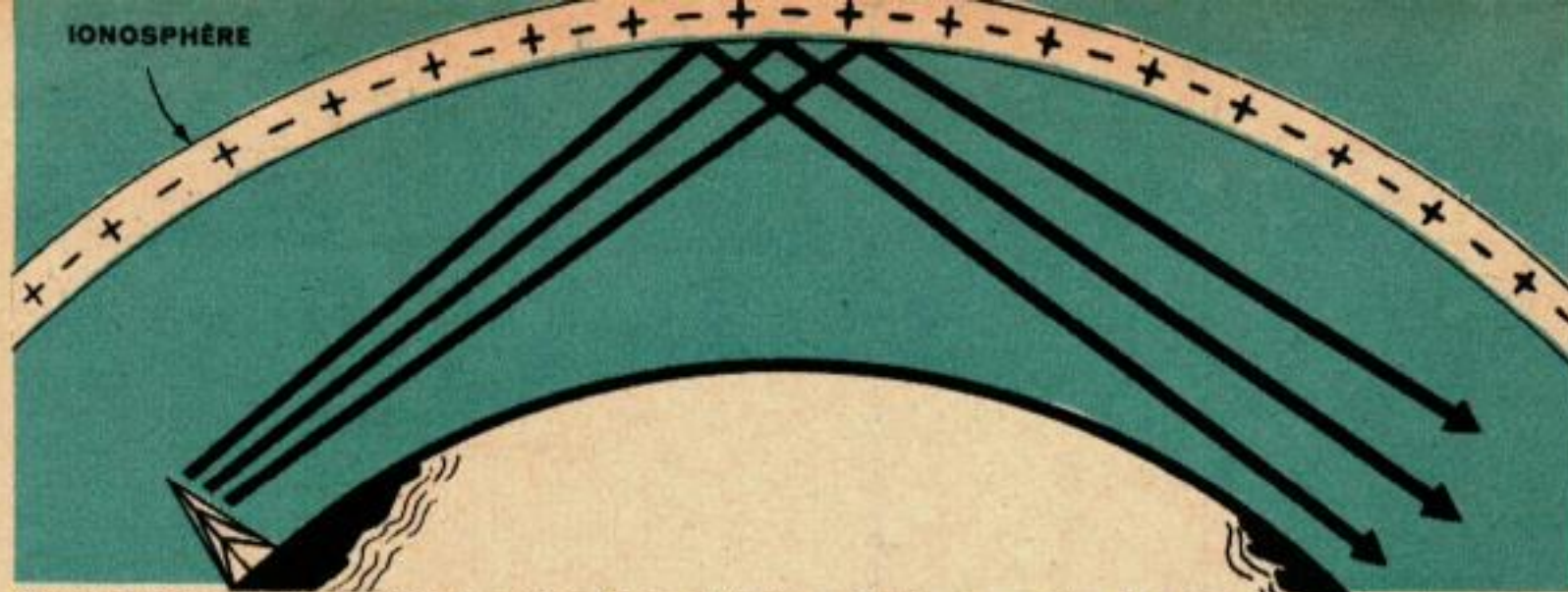
Figure 1. L'ionosphère réfléchit les ondes à basse fréquence. Ci-dessous : Cône de pointe et mécanisme intérieur de la fusée « Bouffée de Fumée ».
