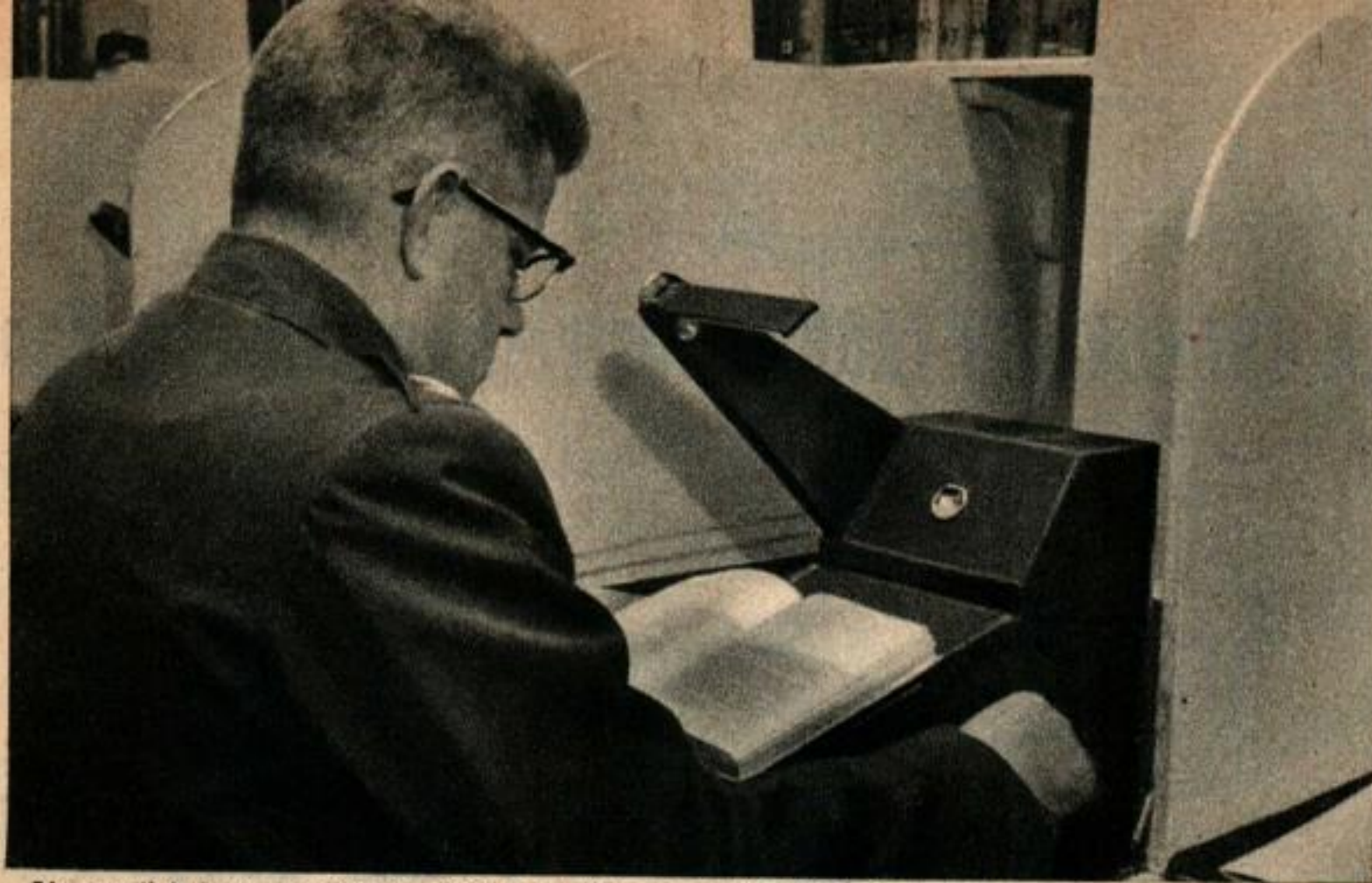
L'appareil de lecture projette un trait de lumière qui se déplace de haut en bas sur la page que lit l'officier.
