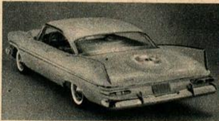
Il est possible d'obtenir, avec supplément de prix, un faux couvercle de roue de secours embouti dans le couvercle de la malle arrière. Les ailerons de queue en oblique sont également nouveaux.
