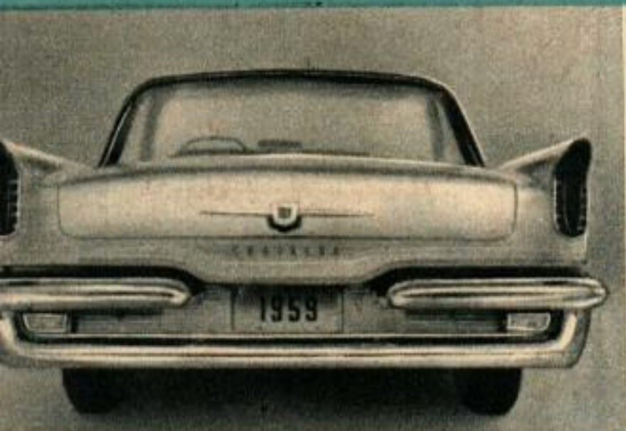
L'arrière de la carrosserie est entièrement nouveau. Le pare-chocs 1959 est plus massif et il comporte une pièce rapportée intérieure en aluminium anodisé.
