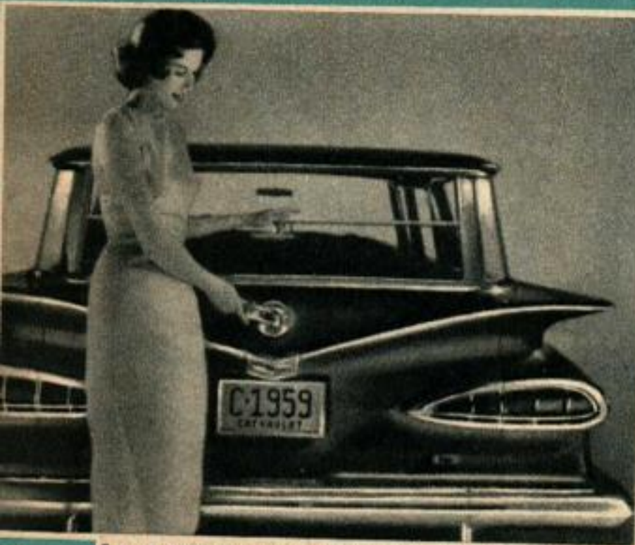
Les « station-wagons » ne comportent pas de demi-portière supérieure à l'arrière. La vitre descend dans la moitié inférieure de la porte, soit manuellement, soit électriquement (avec supplément).
