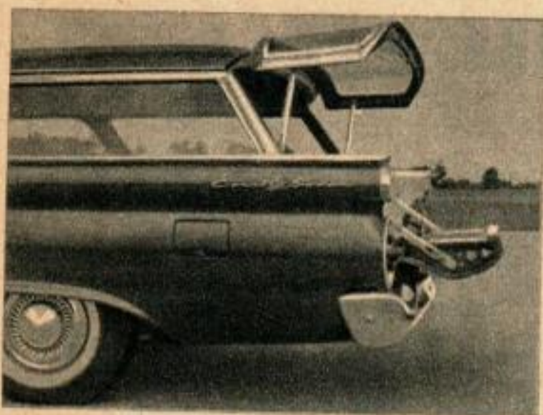
Contrairement à la plupart de ses concurrents (qui montent des vitres descendant dans le panneau inférieur), Ford présente ses station-wagons avec des portes arrière classiques en deux sections.
