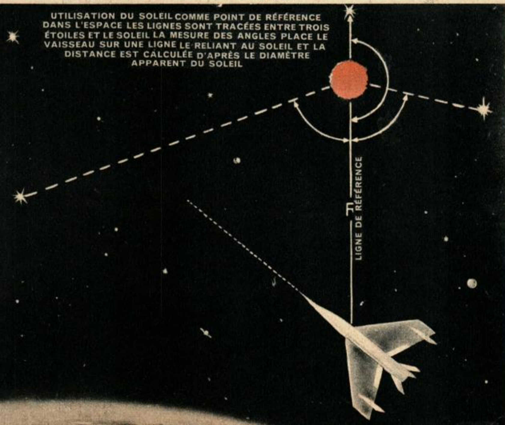
Figure 3 : Le point peut être fait de l'intérieur de l'engin en mesurant les angles de trois étoiles de référence et du Soleil.
