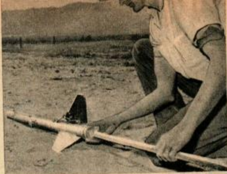
Un maximum de précautions de sécurité est observé pendant la période critique du tassement du combustible solide dans le corps de la fusée.
