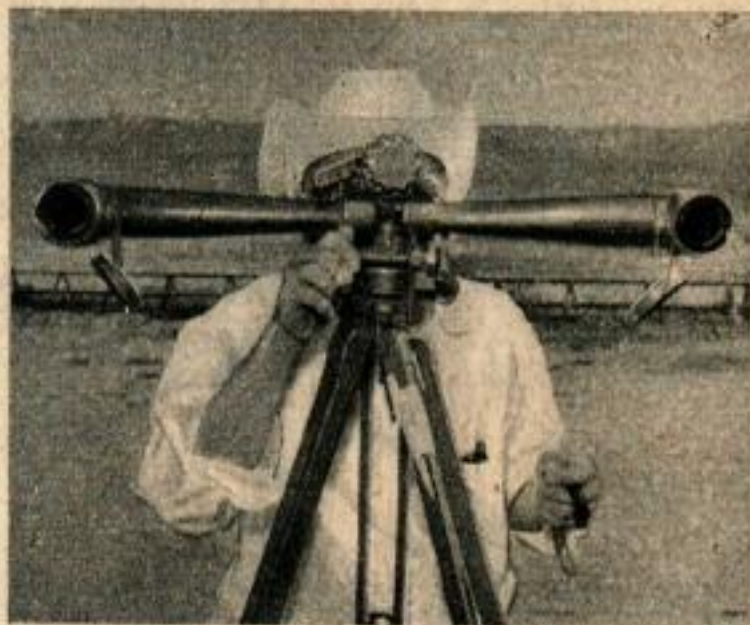
Ce membre d'une équipe d'observation suit la chute de la fusée et enregistre son gisement. L'emplacement de la fusée enterrée est ensuite retrouvé par triangulation.
