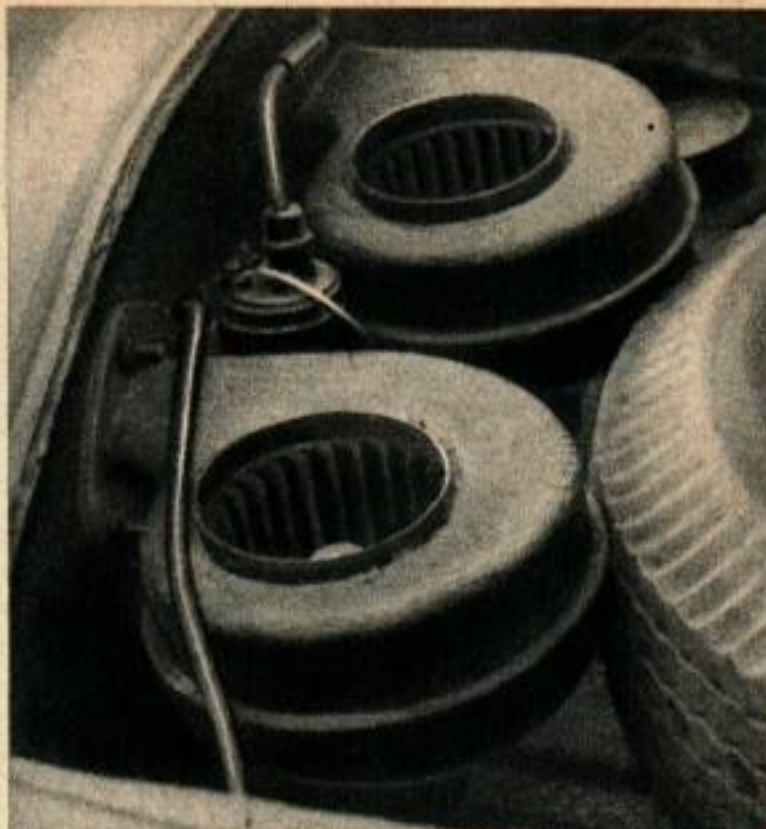
Les compresseurs d'air pour le dispositif réacteur des tuyaux d'échappement sont à l'arrière du coffre de la voiture. La bobine visible entre ceux-ci sert à l'allumage des bougies montées dans les tubes de sortie.
