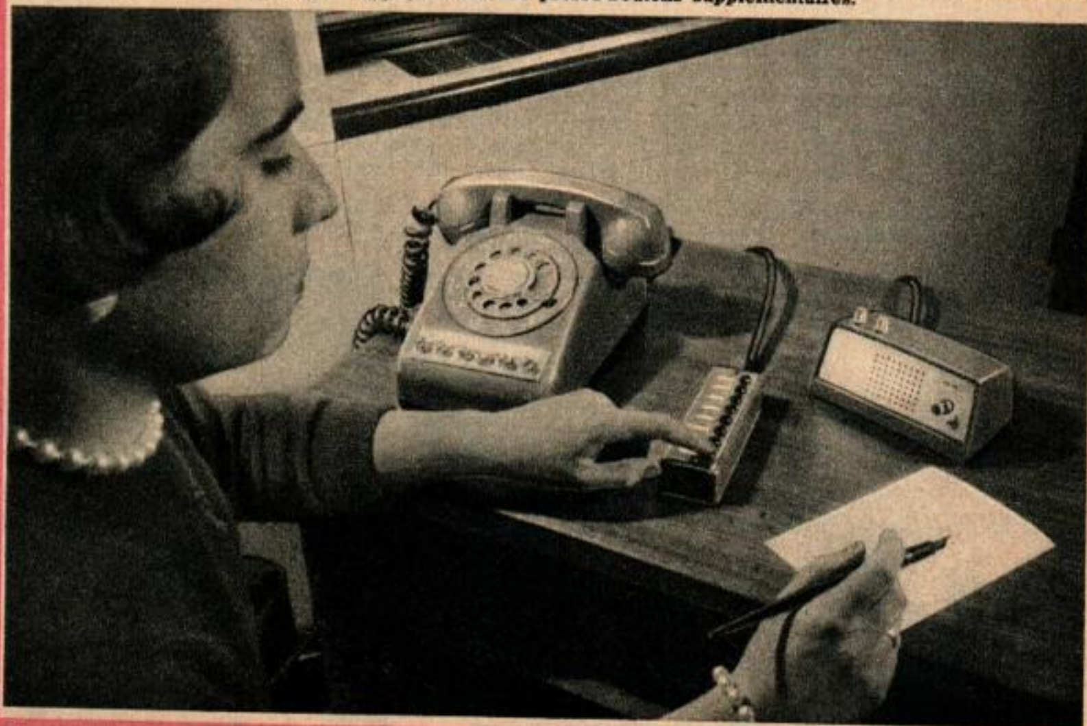
L'opératrice de ce téléphone à haut-parleur peut organiser une conférence entre des postes éloignés et des postes locaux, en appuyant sur des presse-boutons supplémentaires.
