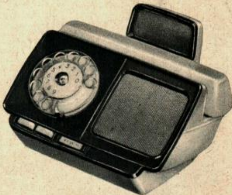
Le We-Ge-Phone suédois comporte un petit haut-parleur à côté de son cadran, et permet à des particuliers ou à des groupes de tenir des conversations à plusieurs voix.
