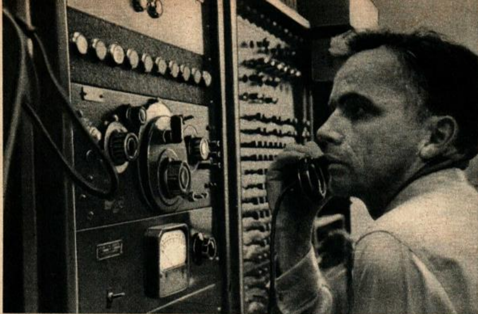
Cet ingénieur de la Compagnie Bell fait la démonstration de l'appareillage électronique « Audrey » qui réagit « intelligemment » à dix nombres parlés.
