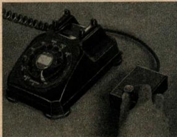
Ci-dessous : Le petit appareil de commande de variation de volume que l'on voit à côté du téléphone amplifie la réception sur n'importe quel appareil téléphonique, dans une proportion pouvant atteindre 16 décibels.
