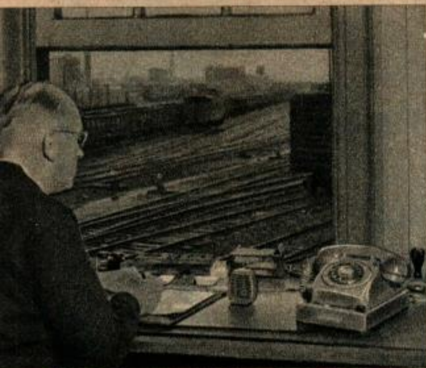
Ce téléphone à microphone et haut-parleur indépendants permet au sous-chef d'une gare de triage de parler en conservant les mains libres.
