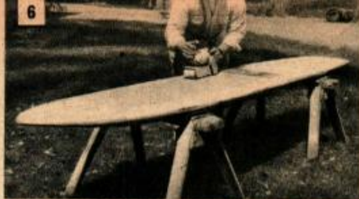
Une ponceuse électrique portable facilite grandement le travail de dégrossissage de l'ébauche en balsa dans laquelle sera formé l'aquaplane.
