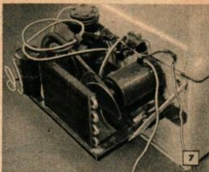
La photo du groupe compresseur, ci-dessus, montre le nouveau moteur, le solénoïde de démarrage et le fil de batterie avec son fusible.
