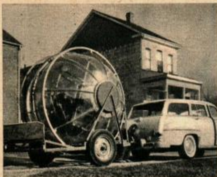
La sphère peut être roulée sur sa remorque spéciale qui est équipée de rails formant rampe.
