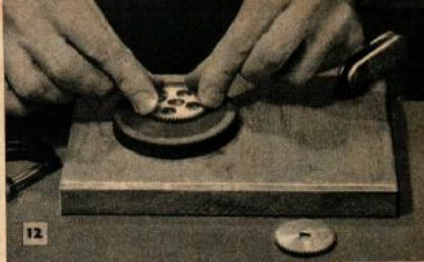
Le polissage ou rodage des petites roues dentées sur une pierre d'établi ronde enlève les bavures, les cabossages ou autres imperfections du métal et donne à celui-ci une très belle finition. Appliquer de l'huile fluide sur la pierre.
