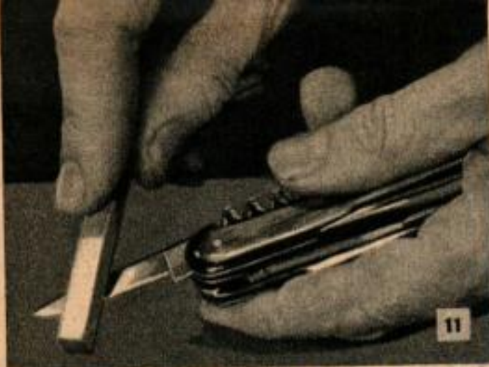
Pour donner un bord de coupe très fin à une lame de couteau de poche, utiliser un bâton abrasif dur. Un polissage avec ce bâton sera suffisant, à moins que le bord de coupe soit encoché ou endommagé de tout autre façon.
