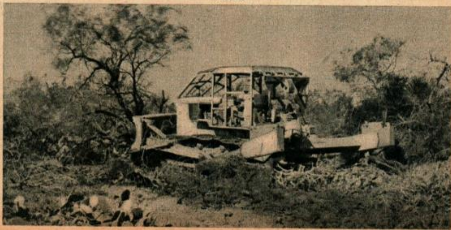
Cet énorme tracteur muni d'un soc spécial pour arracher les racines défriche plus de 12 000 m 2 de brousse à l'heure.
