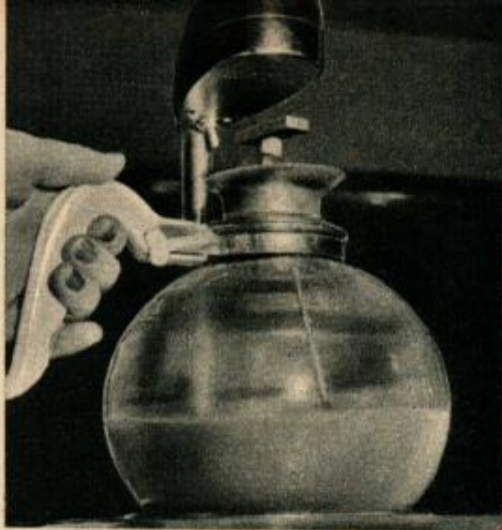
Un aimant entraîné par un moteur électrique et logé dans un carter se trouvant au-dessus de la machine « Silex » fait tourner des palettes en acier inoxydable pour agiter le chocolat contenu dans le récipient.
