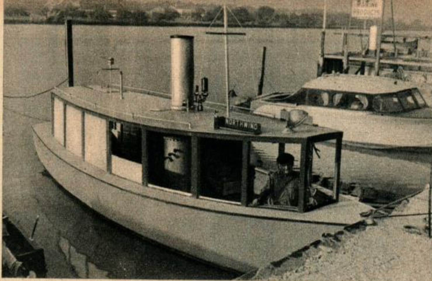
Le seul pontage du bateau à vapeur de construction d'amateur est la « passerelle » supérieure munie de rampes qui rendent de grands services. Toutes les « fenêtres » sont en acier, sauf celles de l'avant.
