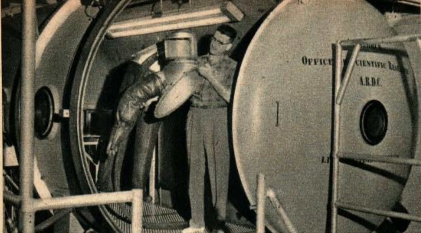
La porte de la chambre à dépression roule sur le côté. Une pompe fait le vide à l'intérieur de la chambre ne laissant dans celle-ci qu'une molécule d'air sur 18 000.
