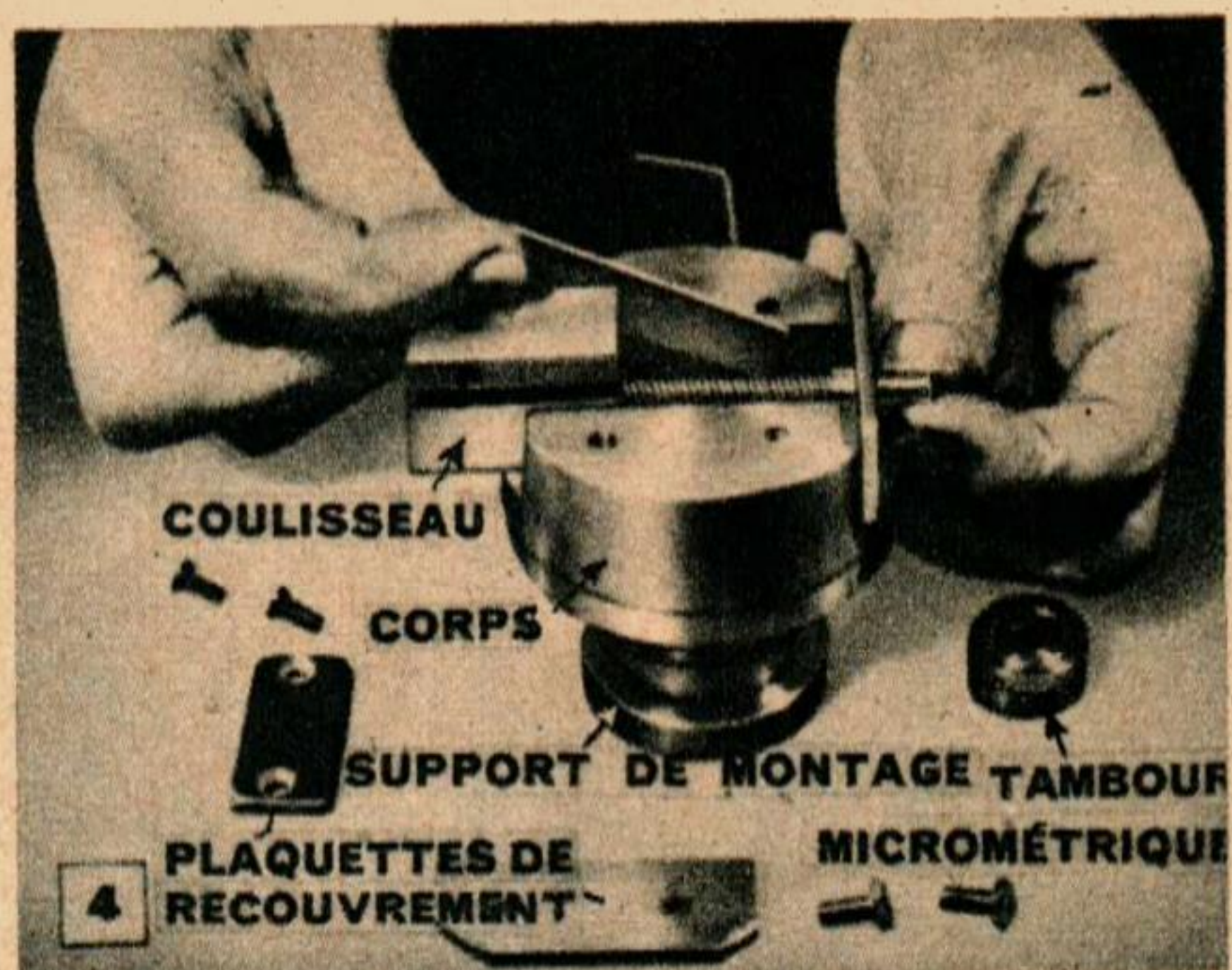
Ci-dessus : Lors de l'assemblage, assurez-vous que les pièces sont en bon ajustement et qu'elles fonctionnent sans aucun coincement. Ci-dessous : montage du tambour micrométrique sur le tour pour la coupe des cinquante divisions de la graduation.
