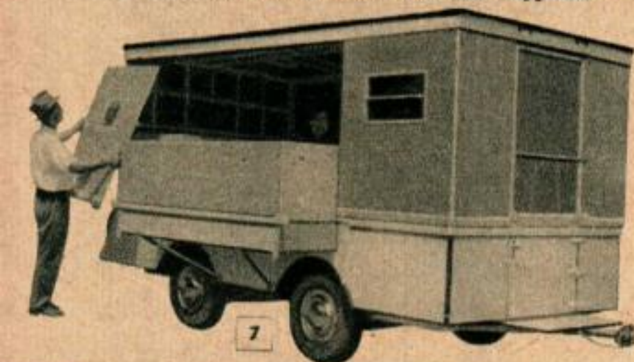
5 Sur cette photo, l'une des parois latérales a été laissée de côté afin de montrer que le dégagement intérieur en hauteur est suffisant pour un homme mesurant plus de 1,80 m, et pour laisser voir comment les couchettes sont installées sur leurs supports.
