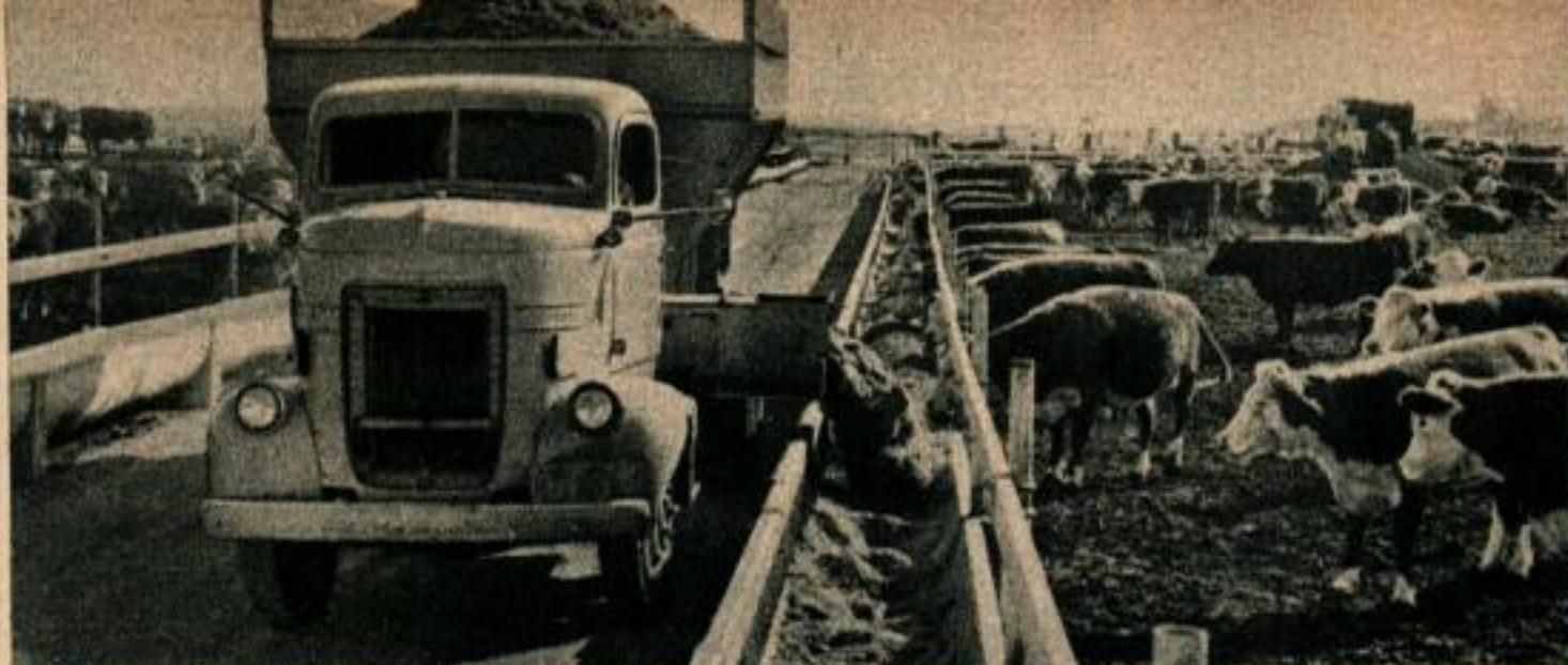
Une autre méthode de distribution des aliments utilise des camions équipés de vis d'Archimède qui délivrent la nourriture dans des auges installées dans les enclos.
