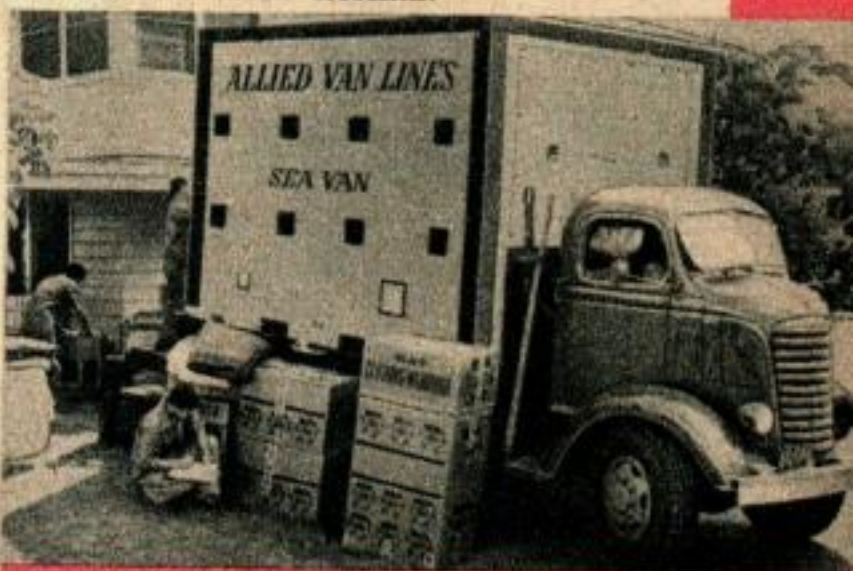
Le « container » mobile « Sea Van » (fourgon maritime) est chargé sur un camion à plateau et sera déposé dans la cale d'un navire pour un voyage transatlantique. Un seul de ces containers peut loger le mobilier d'une maison de quatre pièces. L'extérieur est en contre-plaqué.
