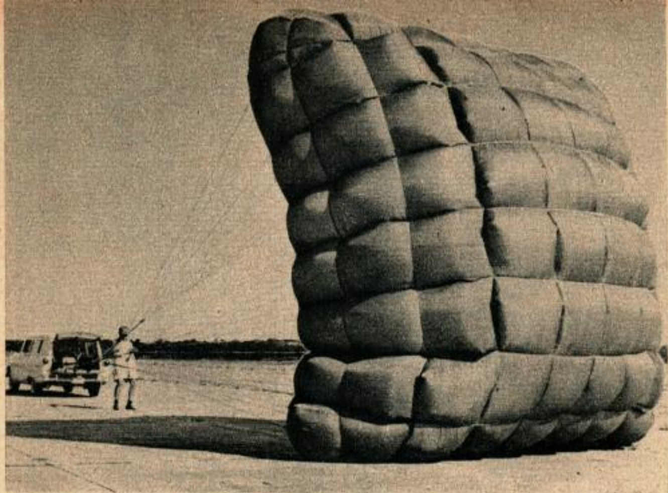
Ce parachute carré du type multicellulaire a un meilleur rendement qu'un parachute rond. Même avec plusieurs cellules déchirées, il peut encore supporter sa charge.
