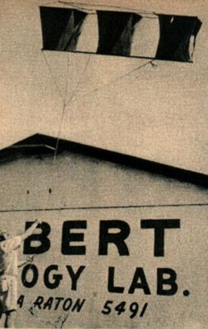
Ce cerf-volant de 1,85 m de longueur avec une envergure de 2,45 m a été construit pour soutenir des dispositifs de mesure de profondeur au-dessus de la surface de la mer des Antilles.
