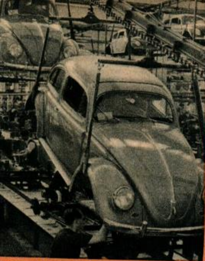
Arrivée des carrosseries en bout de l'une des chaînes. La production est simplifiée par la construction d'un seul modèle de carrosserie : la conduite intérieure à deux portes.
