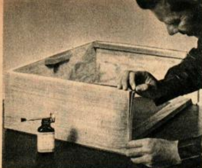
Ci-dessus: collage du ruban-bois d'ébénisterie sur tous les champs du contreplaqué. Ci-dessus à droite: coupe d'une feuillure au long des bords inférieurs, à l'avant et à l'arrière des assemblages d'encadrement des tiroirs.
