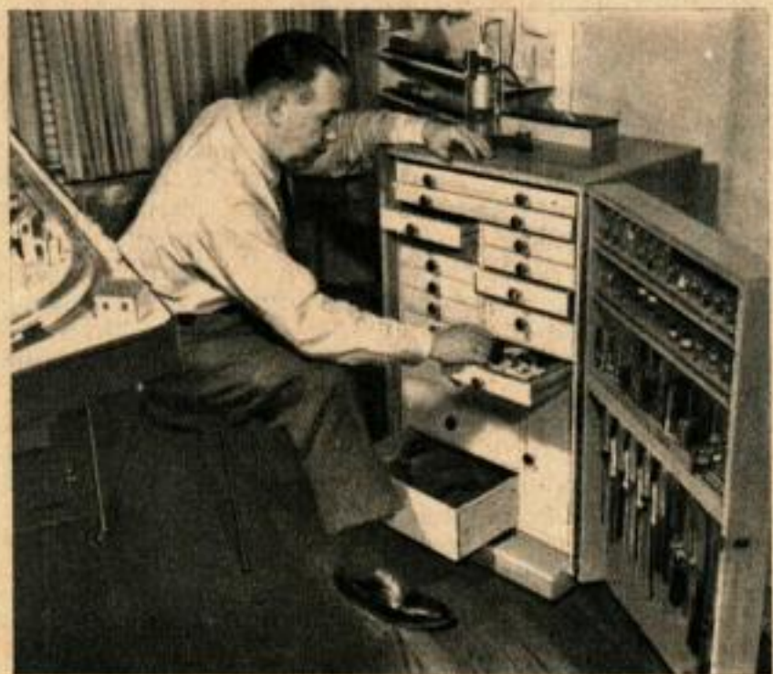
L'ancien placard à instruments dentaires monté sur roulettes orientables que l'on peut voir ci-dessus permet de ranger en ordre parfait toutes les pièces détachées et tous les outils.
