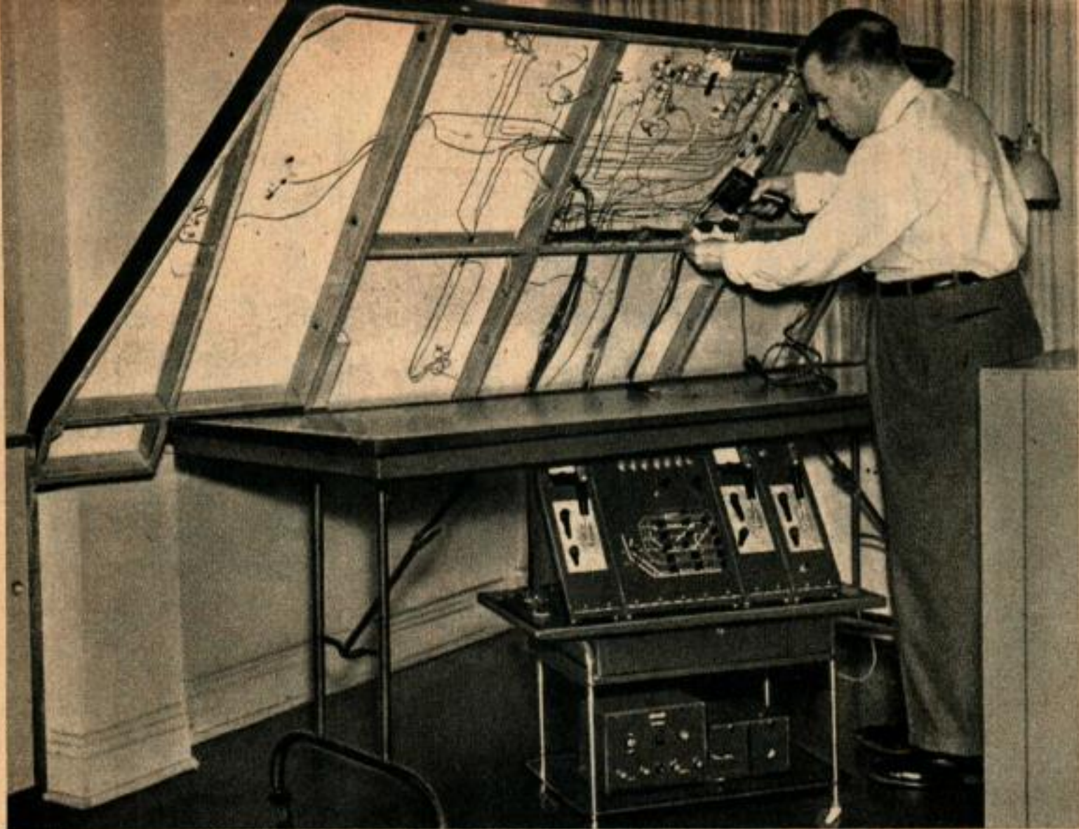
Le réseau s'articule sur des charnières afin de permettre d'accéder facilement au câblage. La table roule sur des roulettes pivotantes qui permettent de la placer à la position de travail la plus commode.
