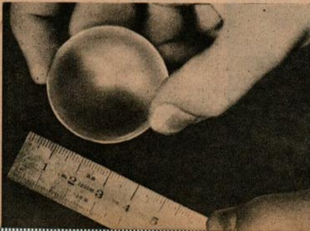
Disque de quartz d'environ 40 millimètres installé dans un oscillateur ultrasonique pour produire des ondes sonores à haute fréquence qu'on utilise pour mélanger des liquides employés dans la préparation de la pénicilline.
