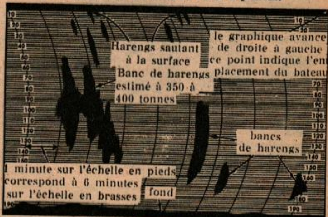
Le graphique d'un enregistreur de profondeurs permet le repérage des bancs de poissons ainsi que l'estimation en tonnes de l'importance de ces bancs. Il permet enfin de connaître le relief du fond de l'Océan et d'indiquer les obstacles pouvant se trouver sous la mer. Ci-dessous le bateau de pêche du Capitaine Lindwall. Le "Linda" 13 m. de long.
