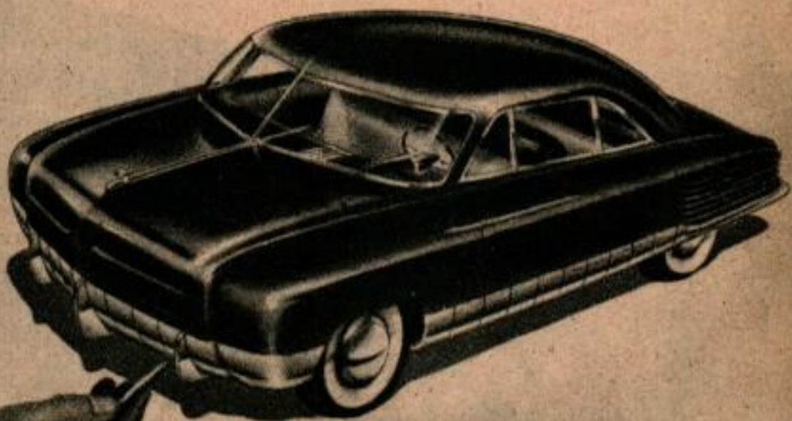
Un des créateurs de la mode automobile travaillant sur une maquette de voiture à moteur arrière et à pare-chocs encastrés. Remarquez les ailes en forme de ponton du modèle reproduit en haut.
