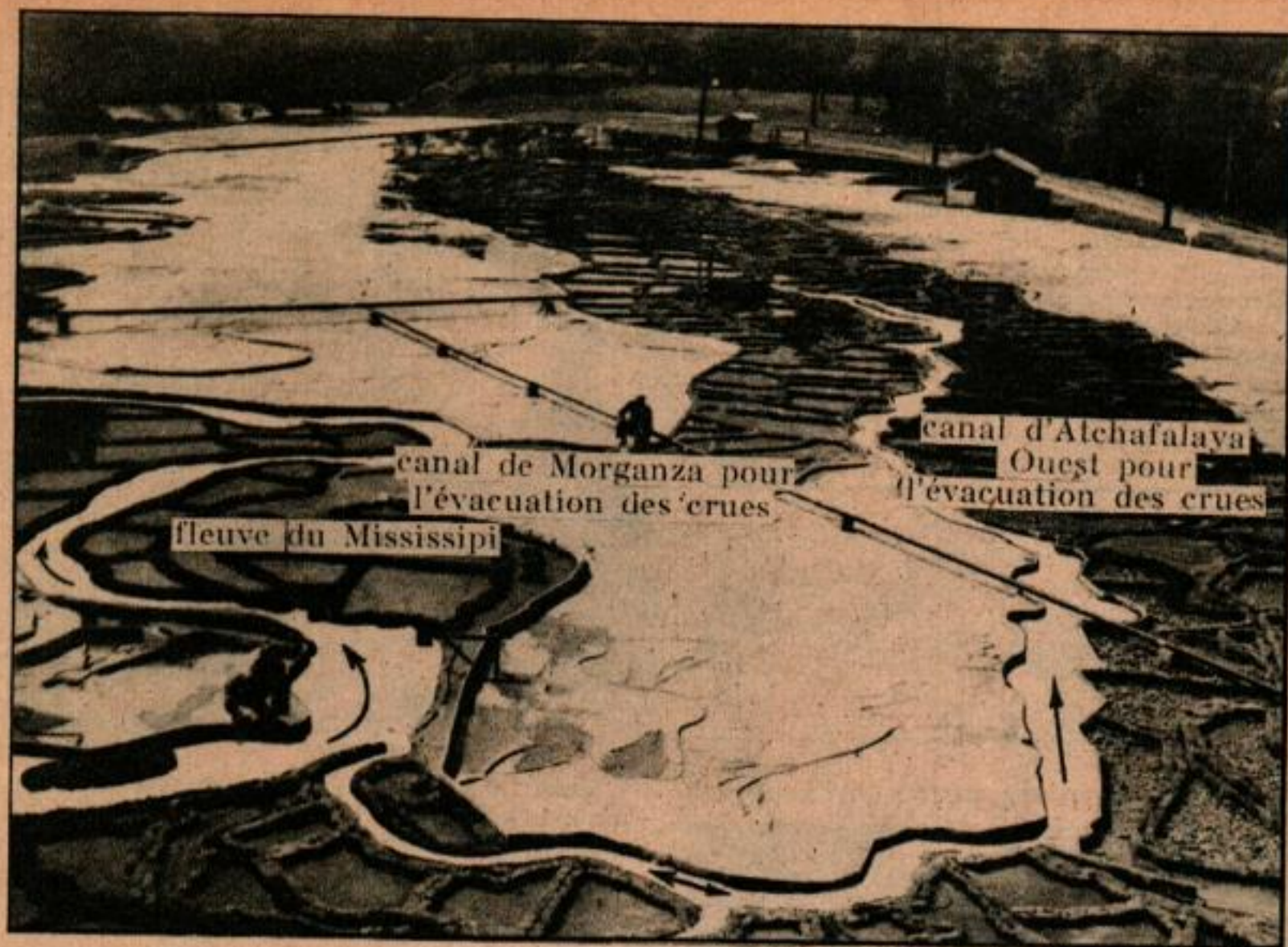
La grande dimension de la maquette donne l'aspect de nains aux ingénieurs hydrauliques qui mesurent le débit de l'eau dans cette maquette du cours inférieur du Mississippi, destinée à étudier la lutte contre les inondations. Ci-dessous, les machines pour produire automatiquement les marées sont visibles à l'extrême droite de la photographie. Cette maquette est celle du port de Savannah. La station expérimentale des voies navigables des E. U. de Vicksburg (Miss.) utilise cette maquette pour l'étude de l'ensablement des passes dans les ports.
