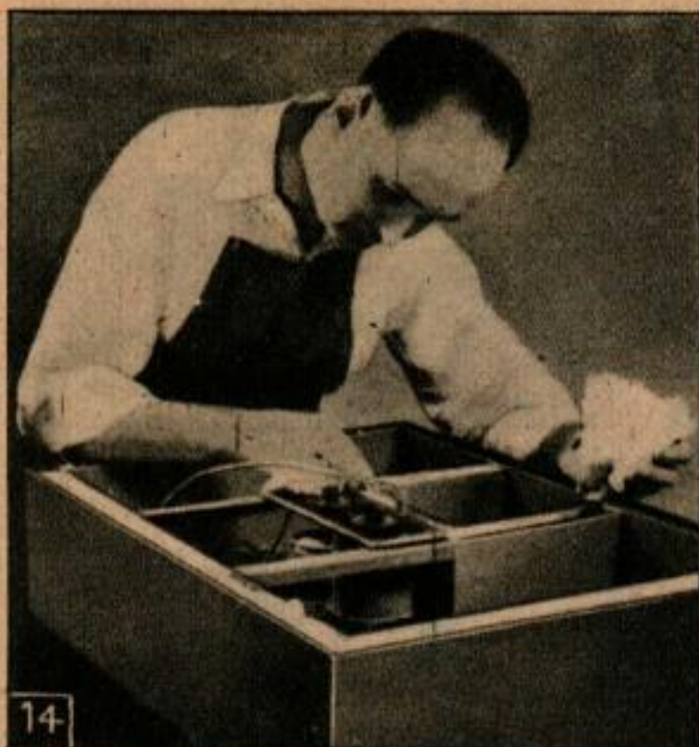
Entre les parois creuses du coffrage, on presse de l'isolant qui est ensuite recouvert de planchettes fortement pressées.
