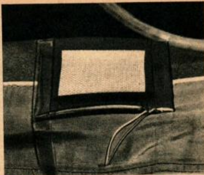
Fig. 3. Le détecteur de pluie est collé avec du ruban adhésif sur le haut du siège avant, avec le grillage branché à la masse tourné sur le dessus, afin d'éviter les courts-circuits possibles.
