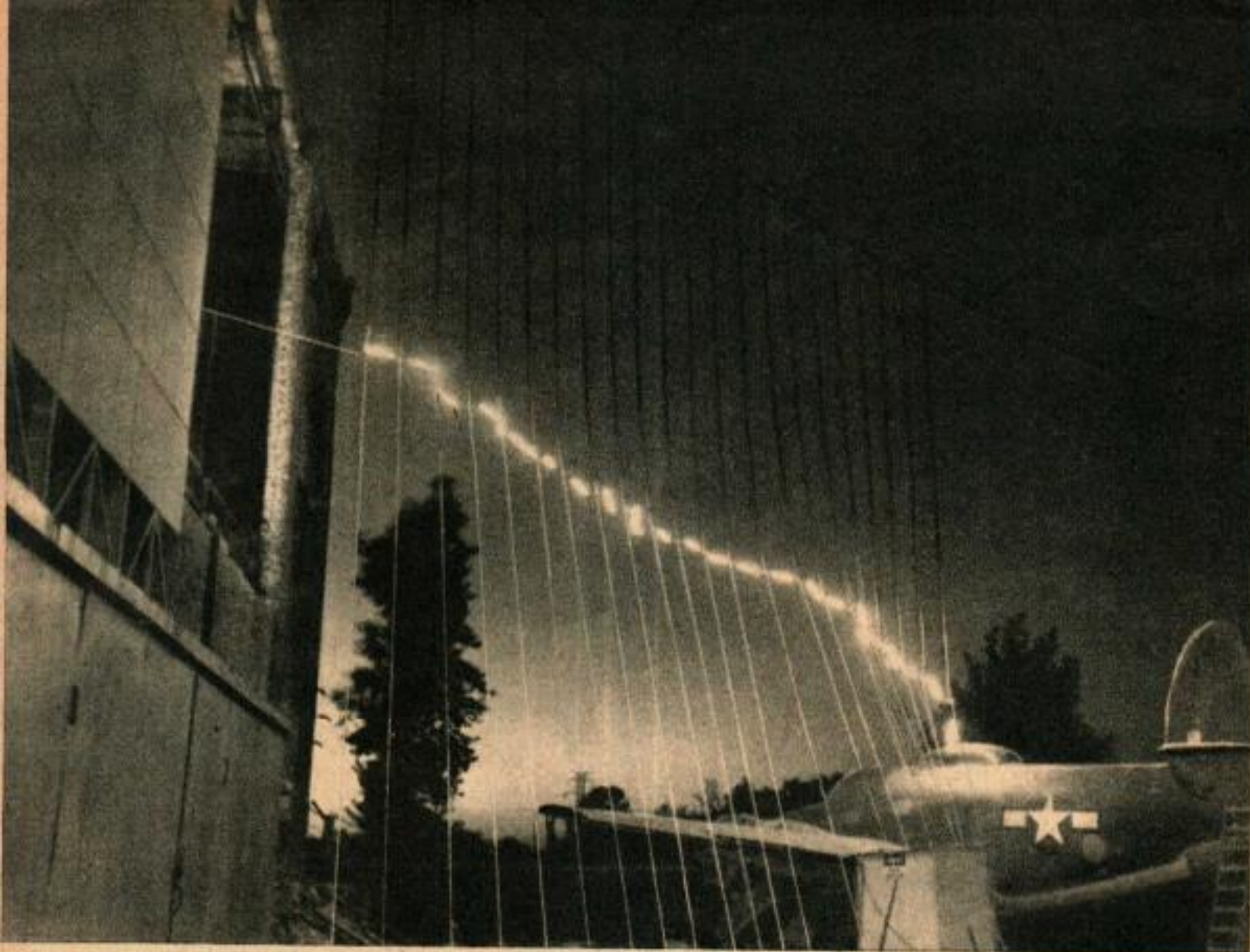
Des tuyaux souples remplis d'eau, guident un éclair artificiel long de 12 m depuis la génératrice du laboratoire jusqu'au capot d'un avion.
