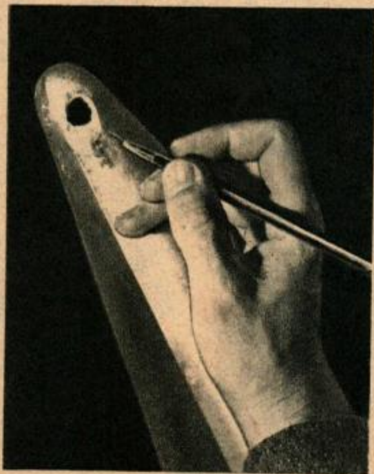
Un trou de la grosseur d'une pièce de dix francs a été percé dans le cône de queue d'un avion à réaction par une décharge naturelle de foudre.
