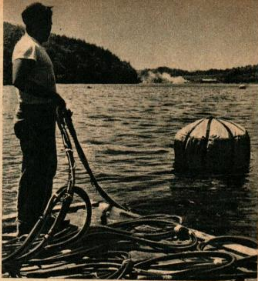
Les bouées faites de sacs en toile à voile élèvent les grumes à la surface du lac, lorsqu'elles sont gonflées d'air.
