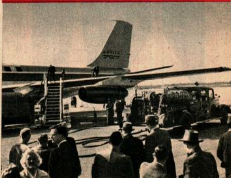
Les énormes réservoirs contiennent 45.000 litres de carburant. Brûlant 6.800 litres à l'heure l'avion peut traverser entièrement les États-Unis et avoir encore une bonne réserve.
