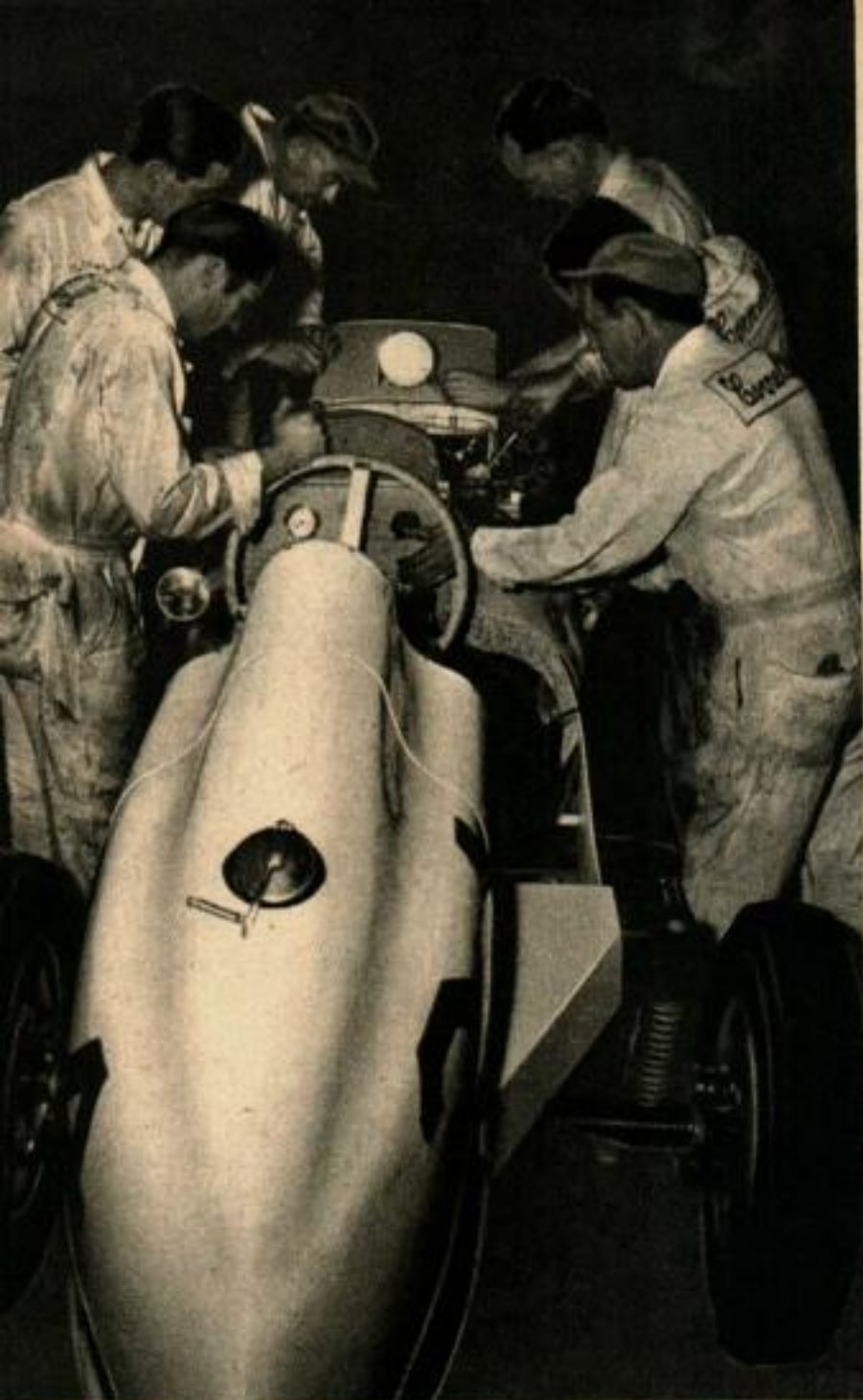
Ci-dessus: la voiture de course à quatre roues motrices conduite par Milliken, a son tachymètre monté au-dessus du moteur, de sorte que le conducteur peut en lire les indications sans baisser dangereusement les yeux. Ci-dessous: une autre de ses voitures est munie de tout un équipement destiné à en mesurer la stabilité.
