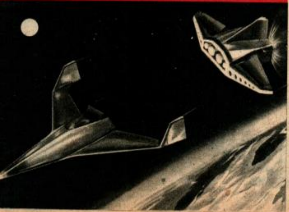
Au cours du voyage de retour, l'appareil se met en porte de vitesse, la pointe dirigée vers le haut, alors qu'il pénètre dans l'atmosphère dense. La pointe extrême brille sous l'action de la chaleur aérodynamique. Ci-dessous : au cas où une défaillance se produirait, la partie motrice pourrait être détachée et l'appareil descendrait vers la Terre comme un planeur.
