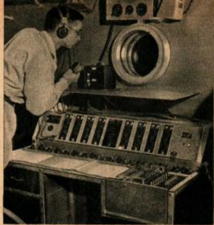
L'appareillage extérieur de la chambre d'essais d'altitude enregistre les effets de l'altitude sur les ondes cérébrales du sujet placé à l'intérieur.
