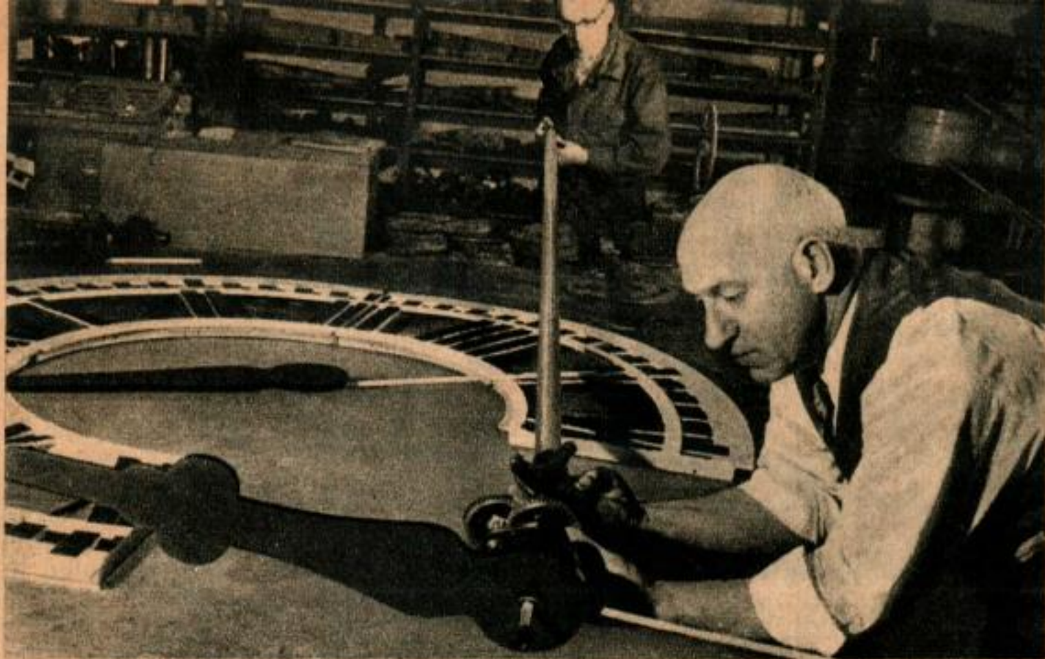
Le nouveau mécanisme de l'horloge est démonté. Les aiguilles en bois de pin des heures et des minutes sont équilibrées par de courtes tiges en fer, peintes en blanc.
