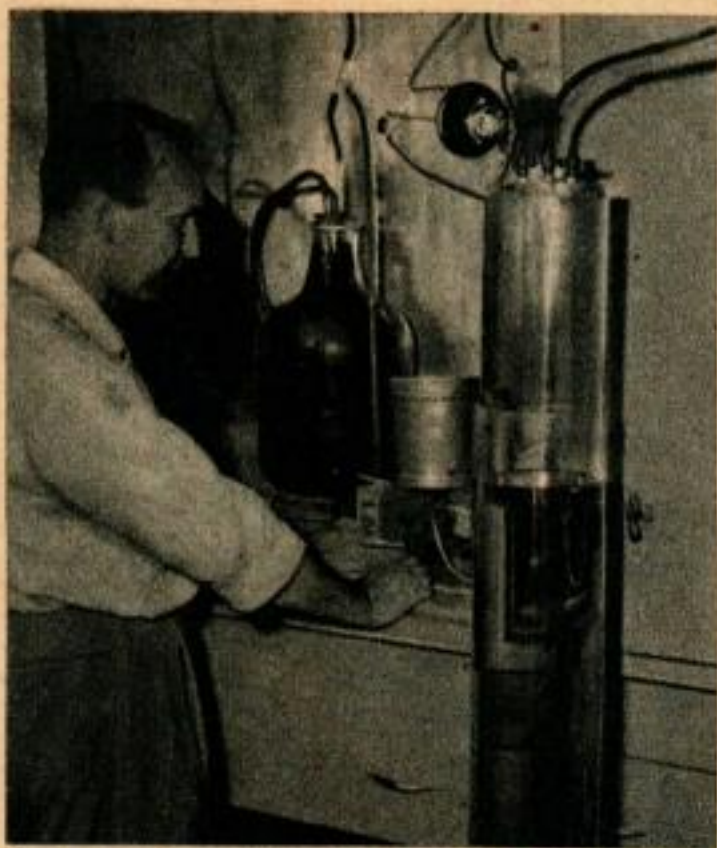
Cet appareil expérimental mesure la quantité de gaz dégagée par les algues desséchées, après traitement pour leur utilisation comme combustible.
