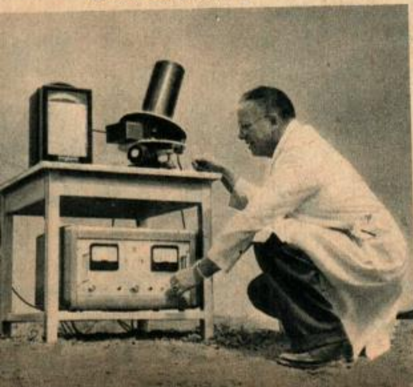
«Le scrutateur du ciel» est un nouvel instrument maintenant utilisé par l'AEC pour détecter la radioactivité dans l'air. Il est particulièrement utilisé pour découvrir les nuages qui contiennent des radiations gamma.
