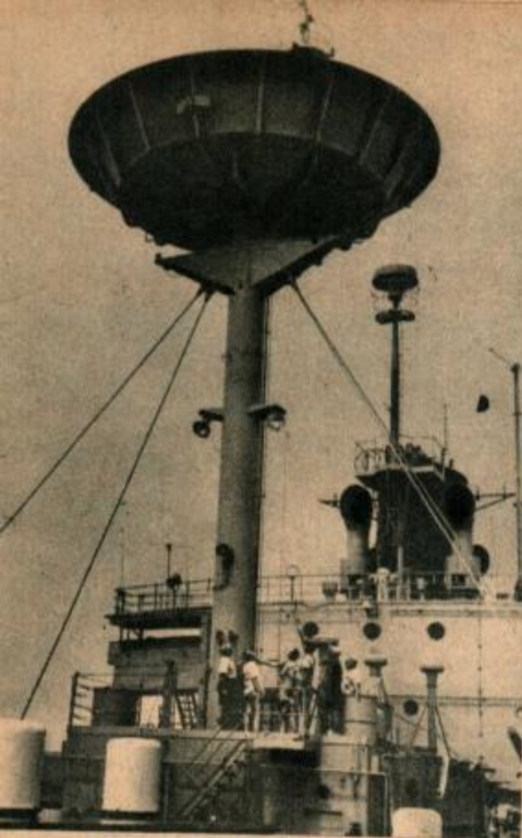
La tour spéciale de ce navire portait des instruments pour mesurer la pluie atomique lors de récents essais d'armes atomiques.
